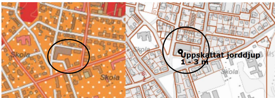
Figur 3. En jordartskarta från SGU, till vänster, visar att marken bedöms bestå av svallsediment och grus. Jorddjupskarta från SGU, till höger, uppskattar jorddjupet till 1-3 meter inom detaljplaneområdet.
