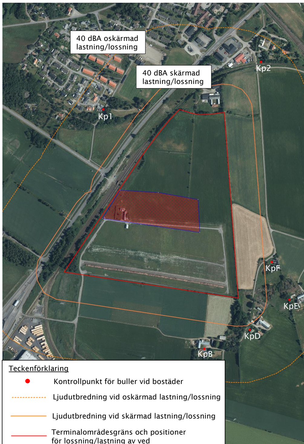
Figur 9. Lossning/lastning av massaved med och utan skyddsvälta eller skärmande vedvälta. Leq 40 dBA på 1,5 m höjd över mark.
