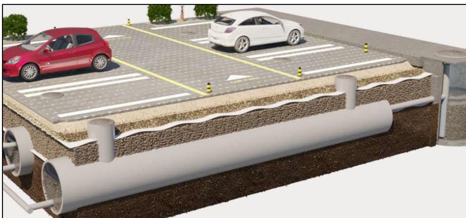
Figur 8. Exempel på fördröjning och rening i rörmagasin. Bildkälla: Werec AB
