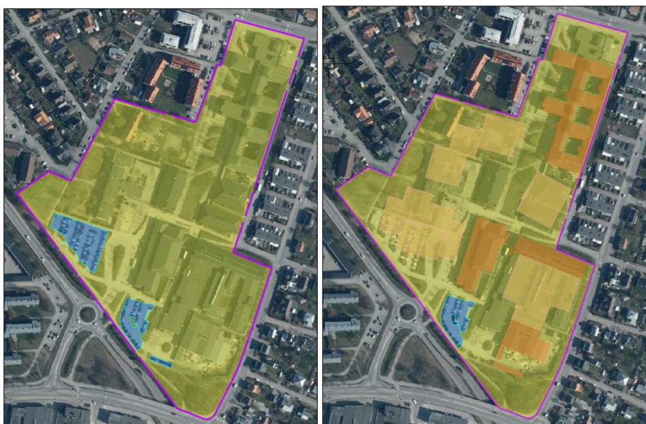
Figur 14. Befintlig (t.v) och framtida (t.h) markanvändning i StormTac. Schablonhalter för skolorråde och parkering visas med gult och blått.
