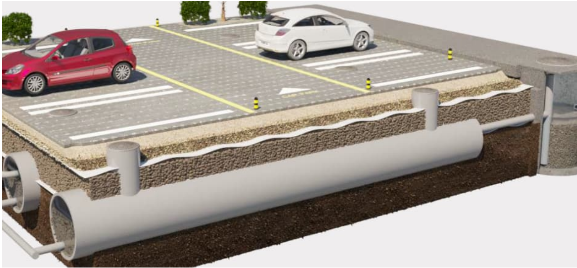
Figur 17. Exempel på fördröjning och rening i granulatfyllt rörmagasin. Bildkälla: Werec AB
