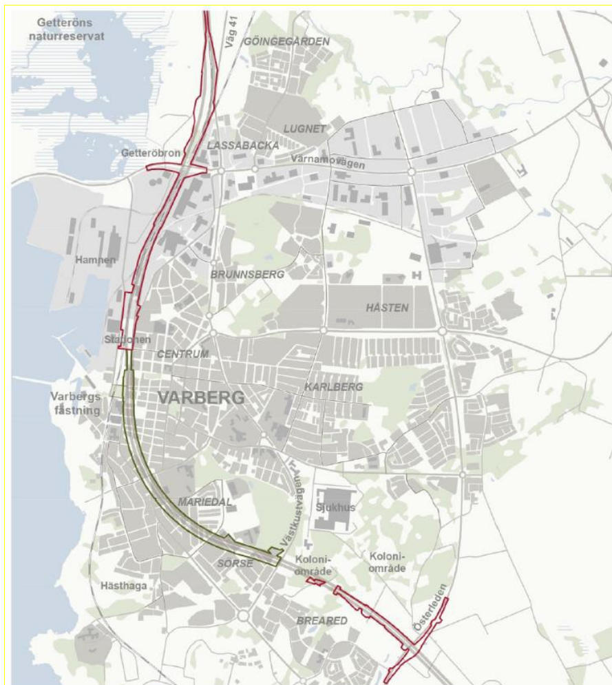
Figur 1. För sträckan Varberg-Hamra tas två detaljplaner fram. Planområdena i "Detaljplan för Västkustsbanan genom Varberg, norra och södra delen" är ovan markerade med rött. Grå markering visar planområdet i detaljplan för bergtunneln.
