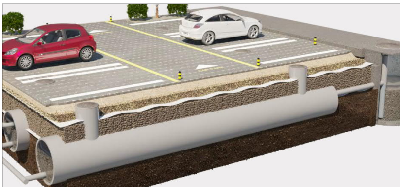
Figur 10. Exempel på fördröjning och rening i rörmagasin. Bildkälla: Weric AB
