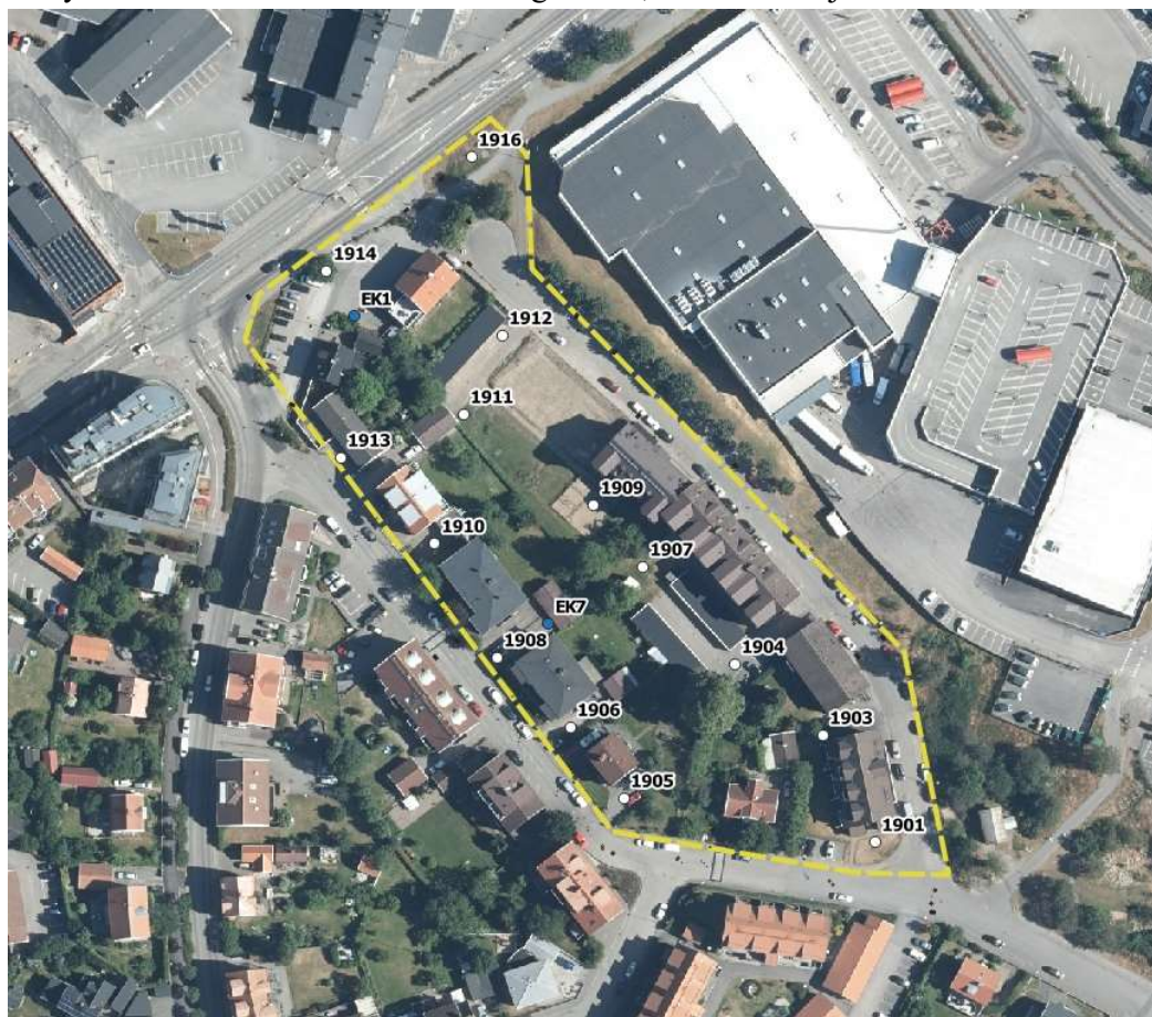
Figur 2. Lägen för provgroparna PG1901-PG1905 (kvadrater) samt preliminära lägen för geotekniska undersökningar (cirklar).
