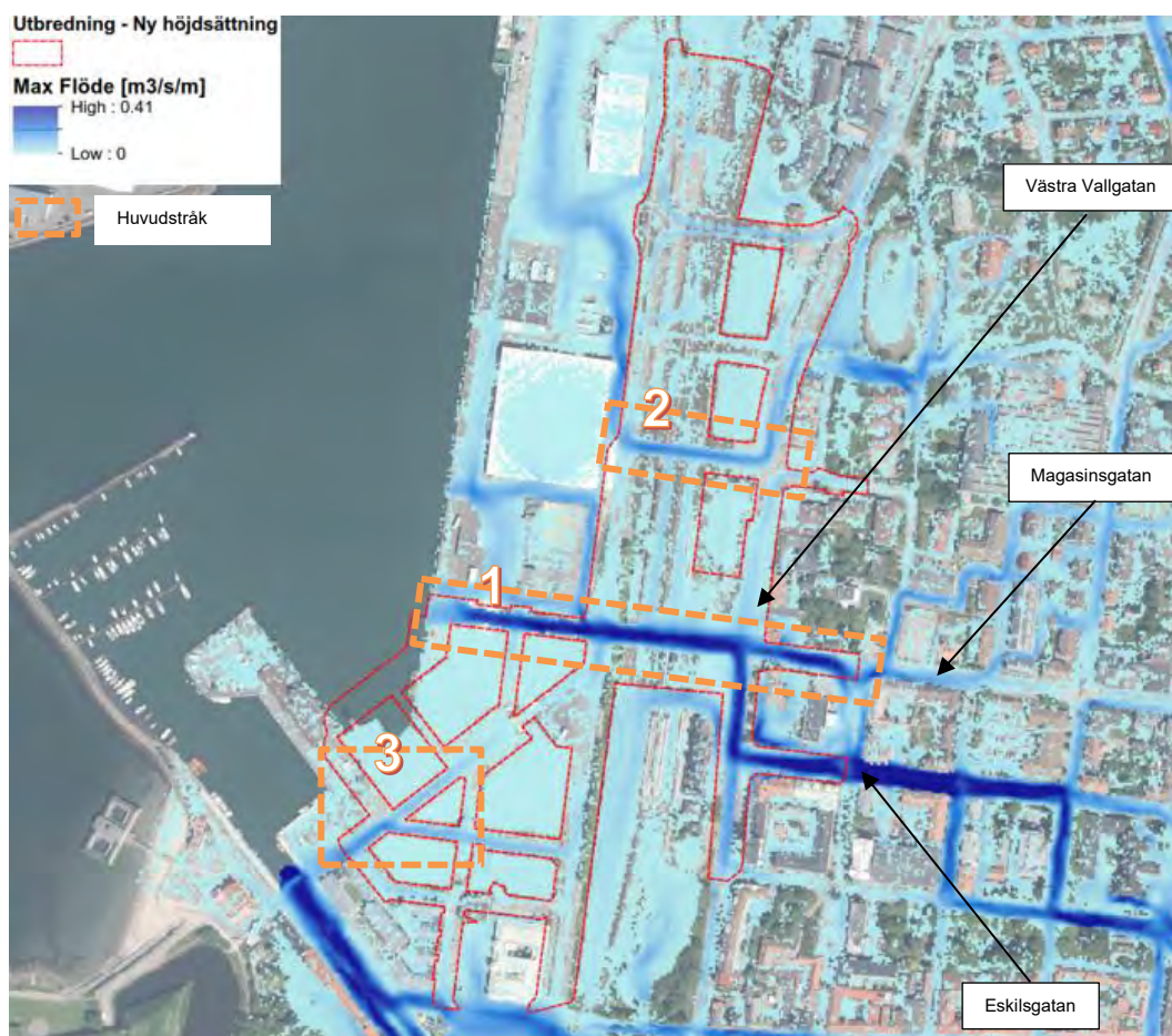
Figur 9. Skyfallskartering med maximalt vattenflöde ( m^3/s per meter) för framtida situation med planerad exploatering. Den största avrinningen inom området med ny höjdsättning markeras som huvudstråk för sekundär ytvattenavledning.
