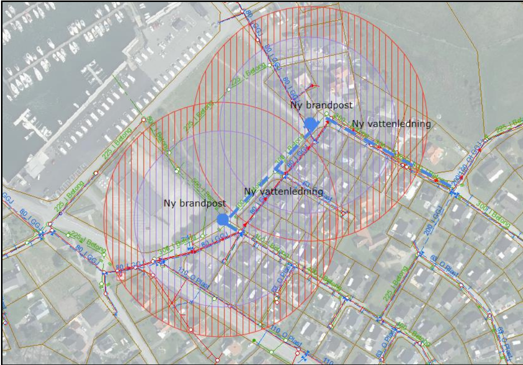
Figur 7. Kartan visar ny ledningsträcka och vilken täckning det blir för de nya brandposterna. Röd ring är radien 100 meter, lila ring 75 meter (PM Brandvatten, Inför detaljplan för Bua 4:94 m.fl., 2020-01-17)
