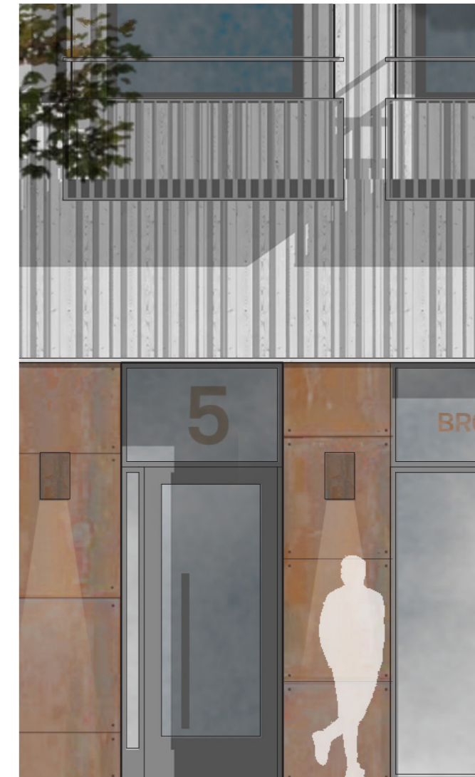
ELEVATION AA - FASADUTSNITT VID BOSTADSENTRÉ 1:50
