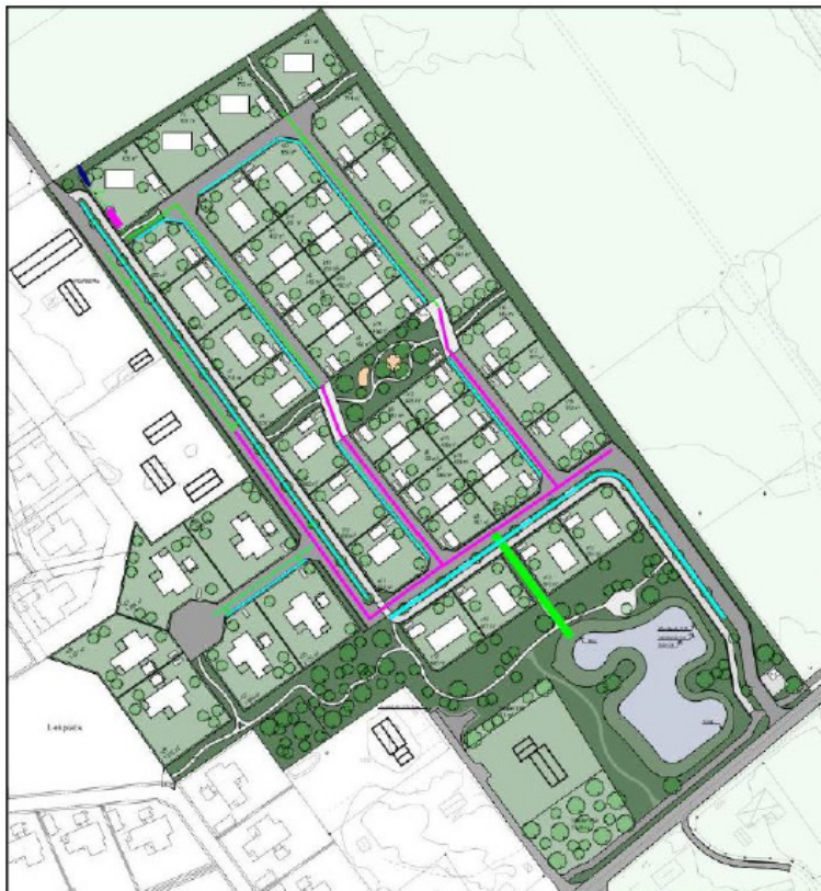
Figur 25. Föreslagen dagvattenhantering inom planområdet. Grön linje visar dagvattenledning, blå linje visar gräsbeklätt makadamdike, magenta linje visar rörmagasin, tjock ljusgrön linje visar inloppsledning till dagvattendamm.
