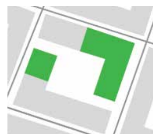
Förtätning på kvartersnivå; genom att parkeringsplatser eller outnyttjade ytor bebyggs kan en högre täthet skapas inom ett kvarter.
