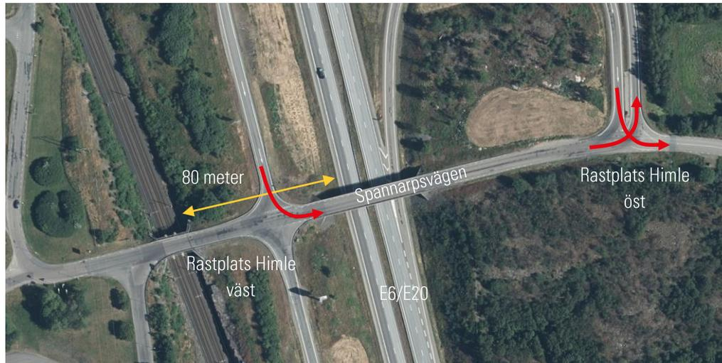
Figur 24. Begränsat utrymme för cirkulationsplats mellan järnvägen och E20 och begränsande vänstersvängar. (Lantmäteriet, 2019) (Redigerad bild: Sigma Civil)
