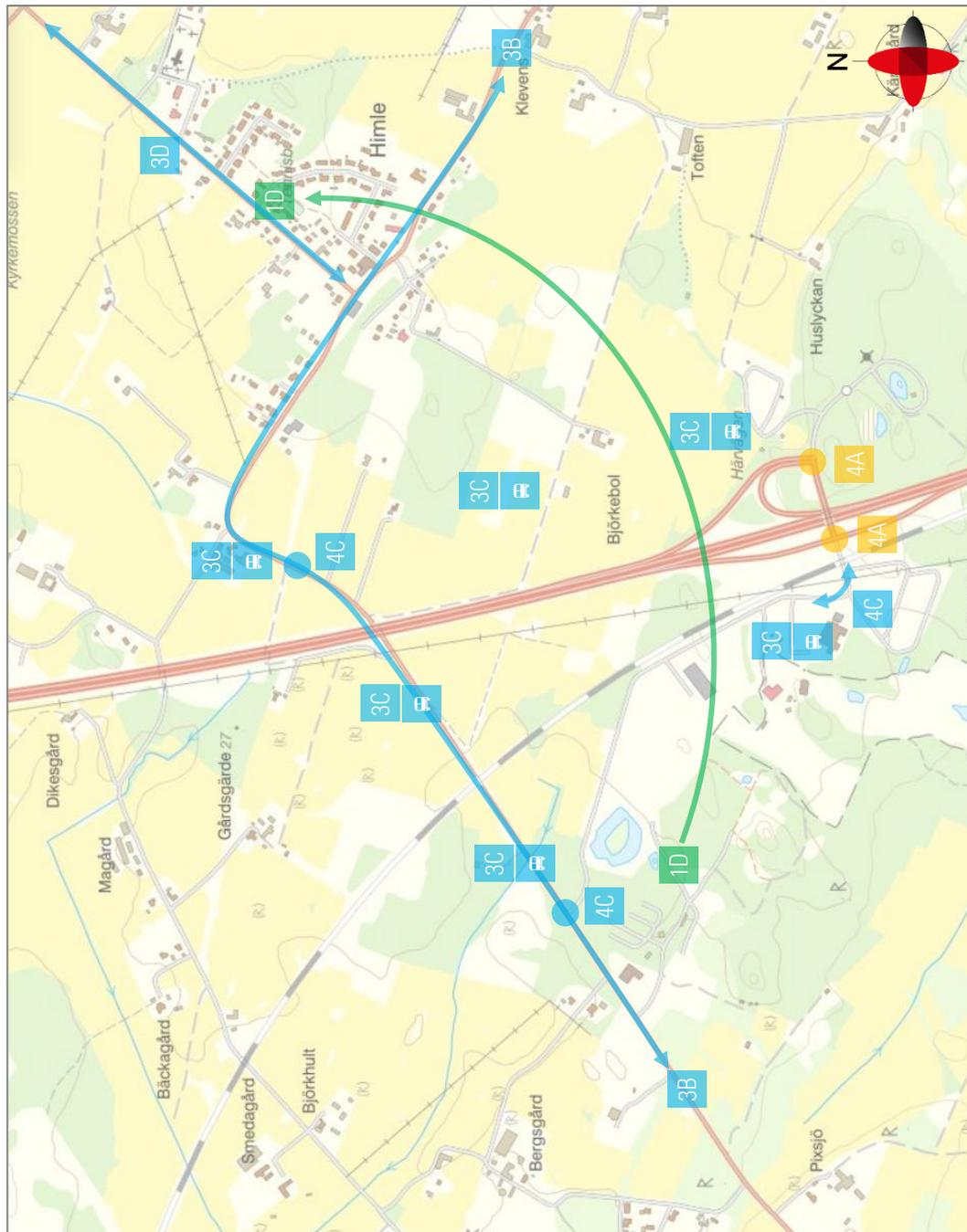
Figur 27. Sammanfattning av vissa åtgärdsförslag (Lantmäteriet, 2019) (Redigerad bild: Sigma Civil)
