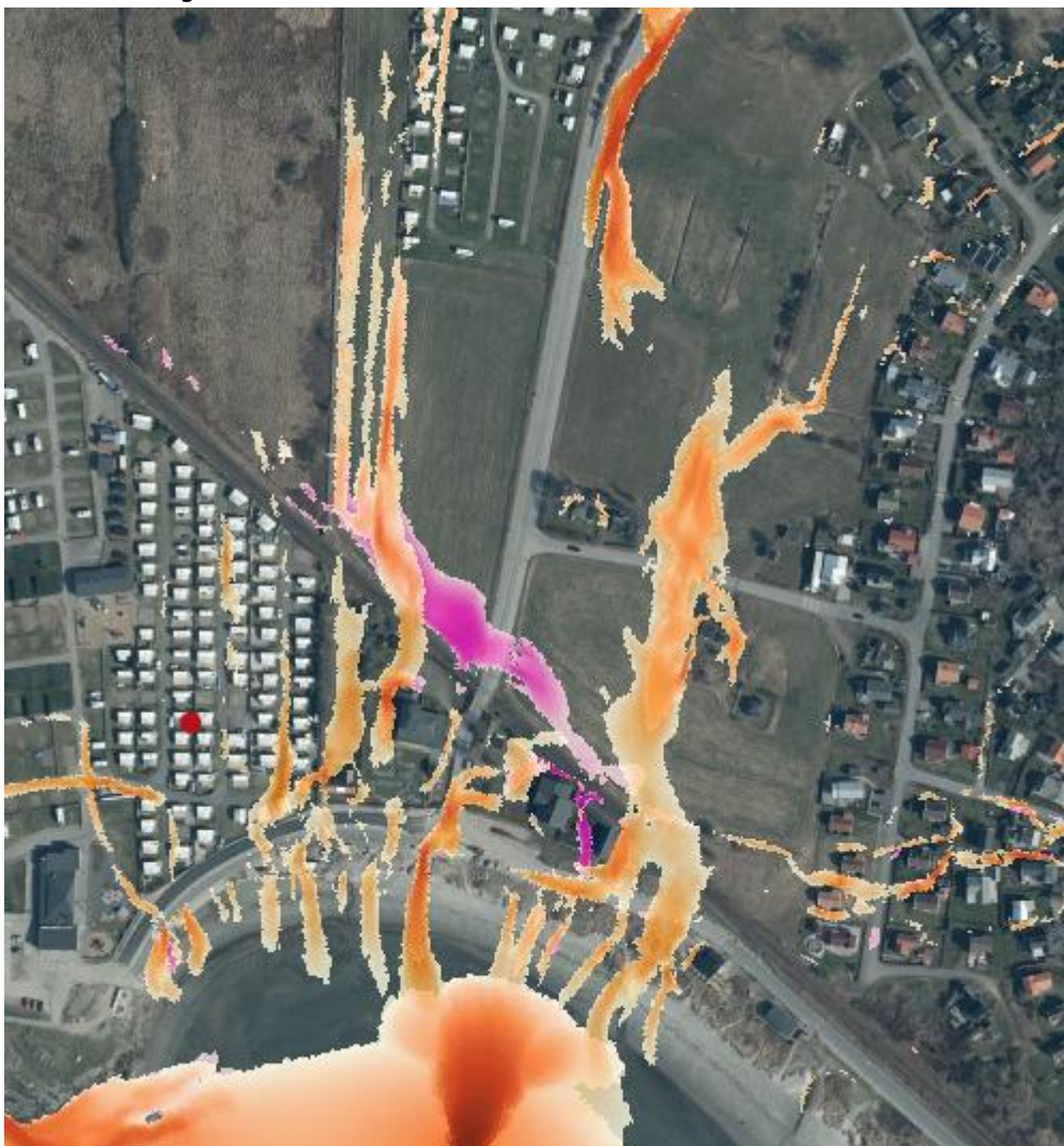
Figur 27 Ändrade flödesvägar vid husvagnsparkeringen och Tångkörarvägen. Orange visar flödesvägar utan banvall och rosa visar med vall.
