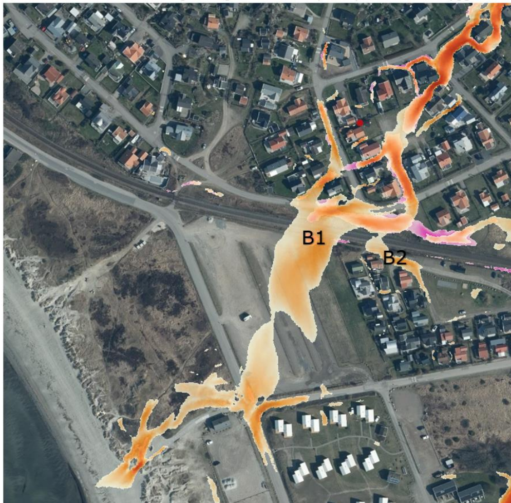
Figur 28 Förändrade flödesvägar vid Solbadsvägen, badparkeringen(B1) och Havsvägen (B2). Rosa illustrerar skyfallsflödet då banvallen är kvar och orange då banvallen tagits bort.
