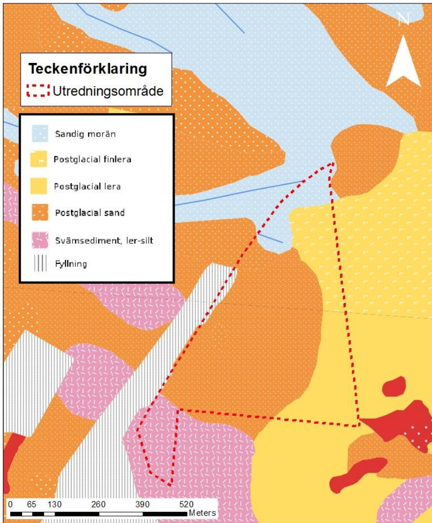
Figur 5: Jordartskarta från Sveriges Geologiska Undersökning (SGU) som visar att utredningsområdet består av postglacial sand, sandig morän och postglacial lera. Kartan är hämtad från SGU:s visningstjänst för jordarter 1:25 000 – 1:100 000 (SGU, 2021).
