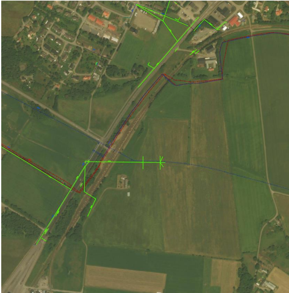
Figur 11: Skärmbild av befintligt ledningsnät enligt utdrag ur VIVABs system i anslutning till utredningsområdet. Gröna linjer är dagvattenledningar, de röda är spillvatten- och de blå är dricksvattenledningar.
