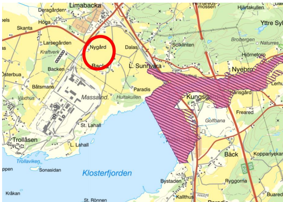
Figur 9: Översvämningsutbredning vid höga flöden i Viskan. Röd cirkel markerar utredningsområdet. Utbredningen är hämtad från Översvämningsportalen (MSB, 2019). Bakgrund: Ortofoto från Lantmäteriets visningstjänst.
