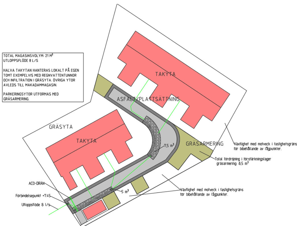
Figur 12 Illustration av föreslagen dagvattenhantering. Total fördröjning i makadammagasin: 12,5 m 3 , fördröjning i genomsläppliga beläggningar: 8,5 m 3 .
